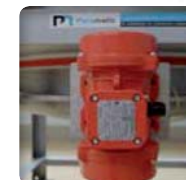
Moteur vibrant pour améliorer l'amplitude et l'intensité du tamis. Ces paramètres sont réglables en fonction de la coulabilité du produit et de la maille
